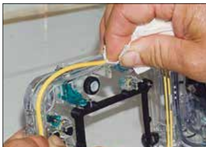
A verificação, limpeza e lubrificação de juntas e vedantes das caixas estanques dos equipamentos electrónicos e lanternas é fundamental para reduzir a possibilidade de alagamento dos componentes sensíveis. (Fonte: https://www.divephotoguide.com/getting-started-with-underwater-photography/underwater-camera-maintenance/ )
