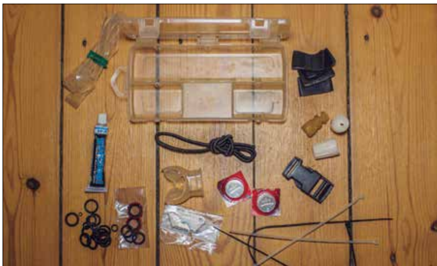
O kit "salva mergulhos" é um conjunto personalizado de peças de substituição rápida por parte do utilizador, que pode garantir, em caso de pequenas avarias no local de mergulho, a viabilidade da atividade. (Fonte: https://scubadiverlife.com/build-save-dive-kit/ )
